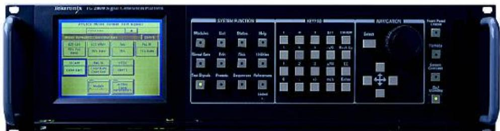
TG2000 是一种多格式、兼有模拟与数字测试信号的精密发生器平台。它的设计目的就是为了解决要求极高的测试应用。TG2000 能够提供基准质量的测试信号，无论是在模拟信号方面还是在数字信号方面，它的功能均得到进一步地增强。用户还可以自行定义测试需求，因此使用十分灵活方便。所有格式中均设有综合测试信号库，还有基于Windows的测试信号开发程序作为补充。TG2000 具有模块式的架构和基于RAM的测试信号发生器，含有可编程的系统时钟，从而保证了TG2000 既能满足用户的当前需要，也能适应未来的需求。
