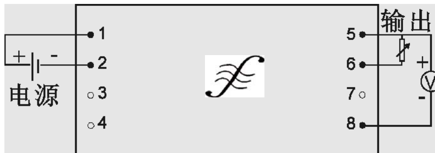
GRBXXX- B B型 产品典型应用接线图 (产品底视图)
