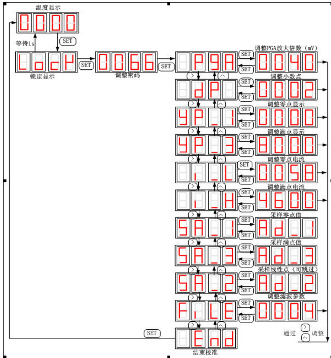
图 2: RC-LED01AT 校准步骤
