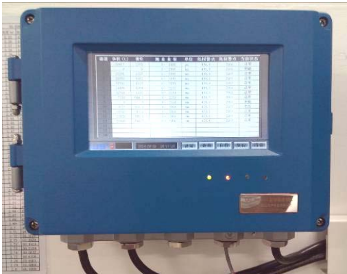
▲HBD-A 巡检仪(可显示 1~16 组油位、温度、体积等参数，可设定高低位报警点，有数据报表记录查询等功能，也可单显)
