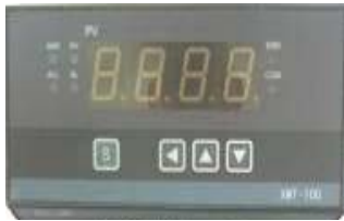
▲XMT-100 智能数显仪 (显示一个液位，可设置四个报警点)
