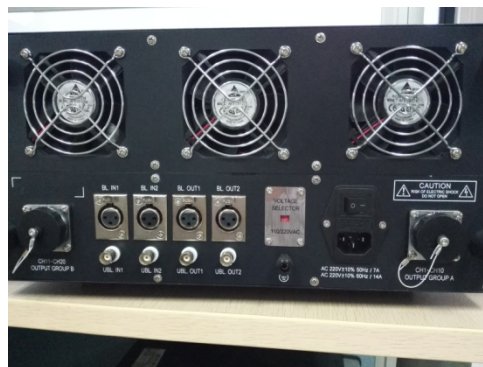
图 8 3 只 120mm 强力风扇进行强制散热，可有效降低机内温度
