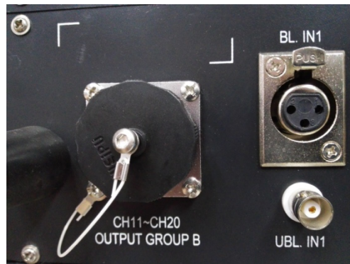
图 7 后置 20 路功率放大器输出接口（10A 带锁定航空插座）
