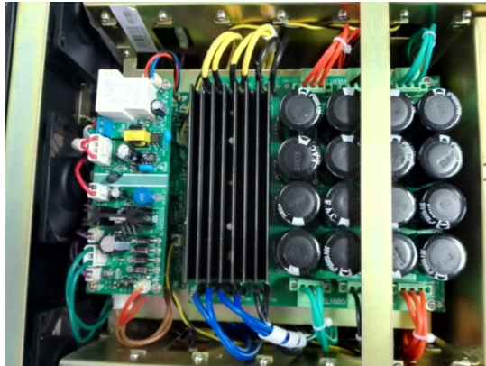
图 2 1350VA 大容量电源组件与辅助电源系统
