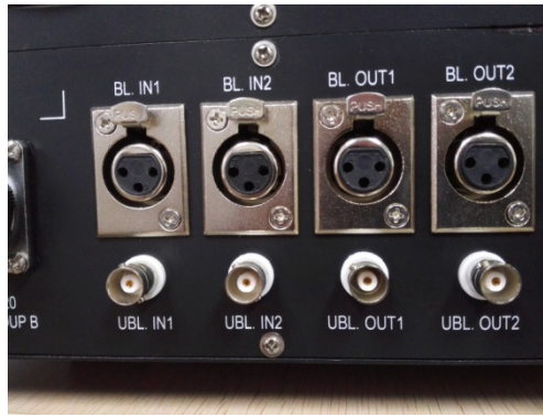
图 6 平衡与非平衡线路输入/输出接口
