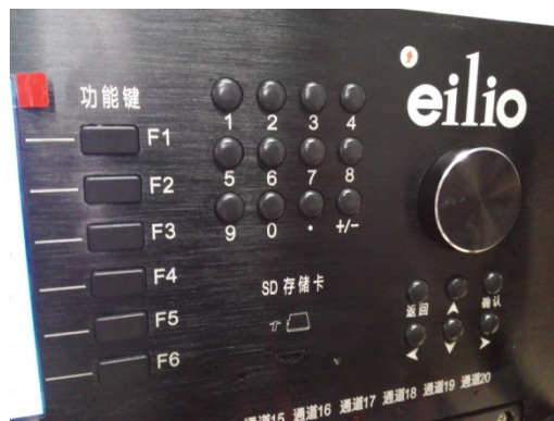
图 4 完善的键盘操作与调节功能设置, 6mm 拉丝铝面板
