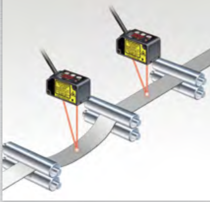
测量铁环材料的歪曲量
