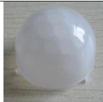
型号: 9002-1, 直径: 23.57mm, 高: 14.5mm, 焦距: 12mm, 距离: 12m, 角度 116 度,
